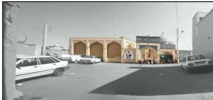
شکل ۱۷: الحاق دیوار و حیاط به مقبره چهل دختران توضیح: بخش الحاق شده با تفاوت رنگ نمایش داده شده است. (منبع: نگارنده)
